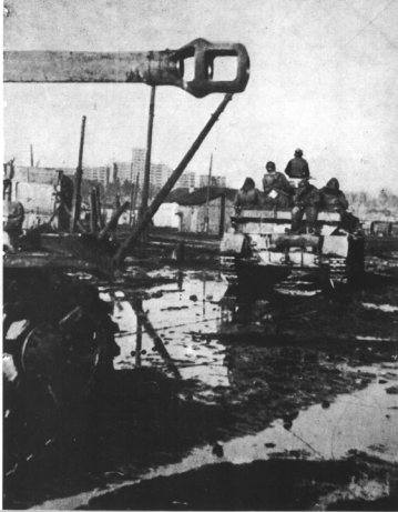
Panzer IV beim Durchrollen von Charkow im Frühjahr 1943. Auf diesem Bild ist besonders gut die Mündungsbremse der KwK L/48 zu erkennen.
