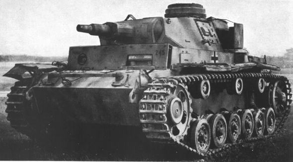
Dieser Kampfpanzer, ein Panzer III mit der 7,5 cm (kurz) Kampfwagenkanone, wird oft mit dem Panzer IV (s. Bild auf rechter Seite) verwechselt. Beide sind jedoch leicht an der Zahl ihrer Lauf- und Stützrollen zu unterscheiden. Diese Panzer III mit einer 7,5 cm Kwk (kurz) kamen 1942 zur Truppe, zu der Zeit, als alle brauchbaren Panzer IV auf die längere 7,5 cm Kwk umgerüstet wurden und somit viele ausgetauschten kurzen 7,5 cm Kanonen verfügbar wurden. Seine genaue Bezeichnung lautete: Panzer III, Ausführung N, Sd.Kfz. 141/2.
