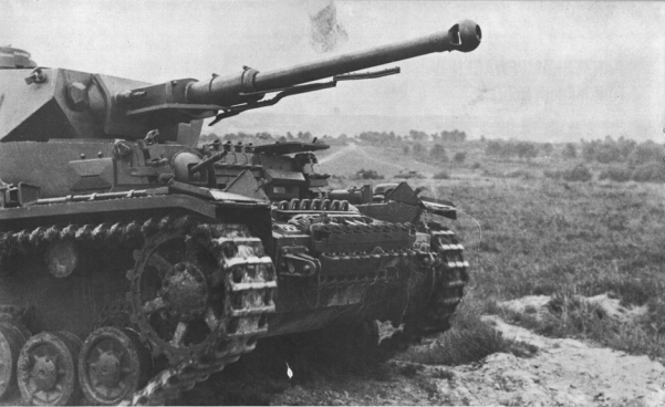
Hier ein Panzer IV (lang) der Ausführung F 2 mit der ersten langen (L/43) 7,5 cm Kwk. Deutlich sind die beiden MG (Bug-MG in Kugelblende) und die Abweiser-Einrichtung unter dem Rohr erkennbar. Das L/43-Geschütz ist an der runden Mündungsbremse mit nur einem Schlitz an jeder Seite erkennbar. Diese Aufnahme wurde im Sommer 1942 auf dem Übungsplatz Coitquedan (Bretagne/Frankreich) gemacht.
