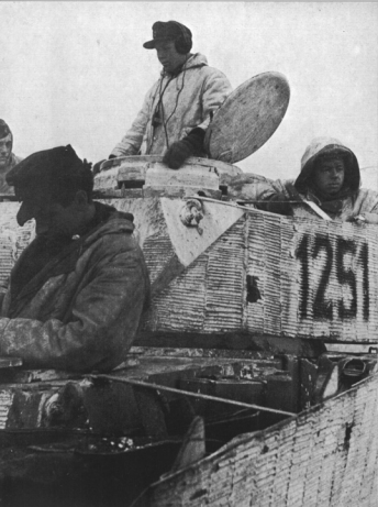
Auf diesem Foto sind gut der Zimmerit (Zement)-Anstrich gegen Haftminen zu erkennen. Die gefütterten Kampfjacken konnten gewendet werden - eine Seite war weiß (meist nicht lange), die andere feldgrau.
