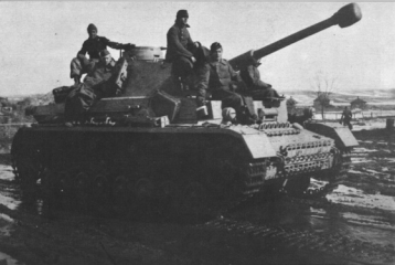
Der Panzer IV in der Ausführung H. Er unterscheidet sich von der Ausführung F 2 durch ein noch längeres Rohr (L/48) und eine größere Mündungsbremse mit beidseitig zwei Schlitzen vor und hinter einem Ringwulst. Die Fotos stammen alle vom Winter 42/43 in Rußland.
